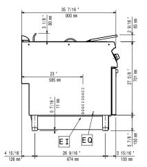
**EI** = Electrical inlet (power) Equipotential screw
